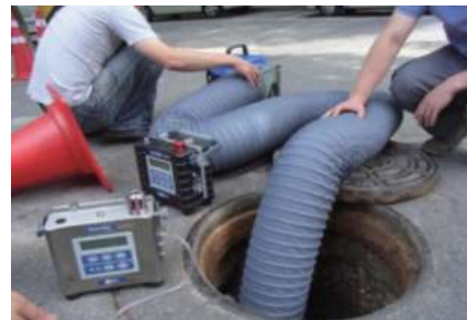
[그림 2-8] 산소 및 유해가스 농도 측정기 및 환기장치
