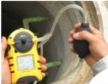
[그림 2-5] 산소 및 유해가스 농도 측정 기기 및 방법(예시)
