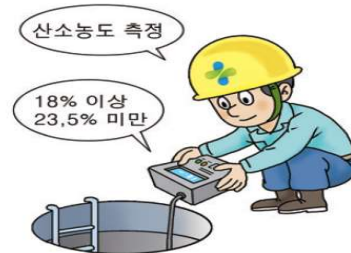
[그림 2-5] 산소 및 유해가스 농도 측정 기기 및 방법(예시)
